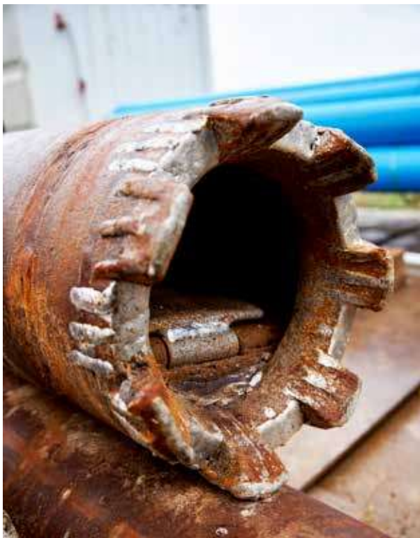
De første ca. 10 meter bores gennem lag af moræneler fra istiden. I disse lag bruges en traditionel boreteknik med foringsrør, snegl og sandspand, indtil oversiden af kalken mødes.
